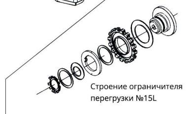
Строение ограничителя перегрузки №15L
