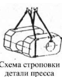
Схема строповки фигурной детали
