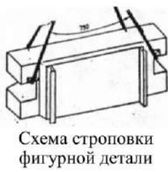
Схема строповки детали пресса
