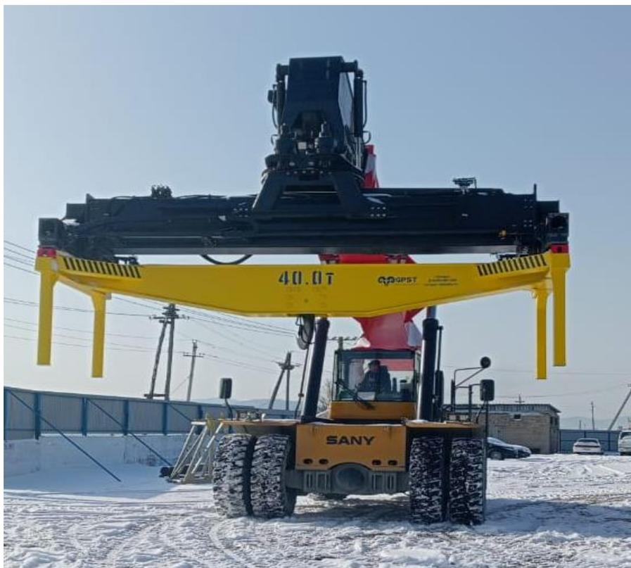
Тип траверсы - пространственная, Н-образной формы. Изготовлена из низколегированной стали 09Г2С. Предназначена для работы с ричстакером. Подсоединение к ричстакеру при помощи контейнерных фитингов, установленных в углах траверсы.
