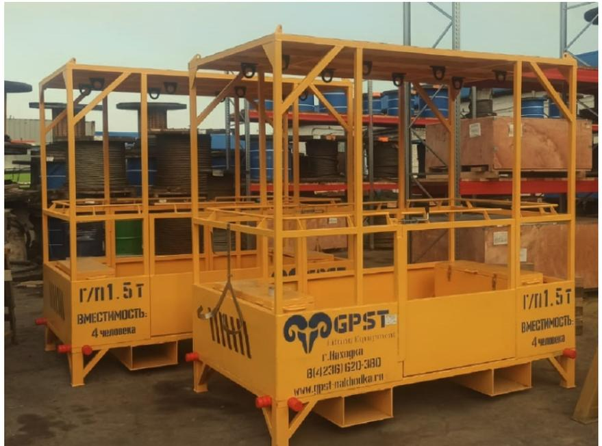
Люлька представляет собой сварную металлоконструкцию прямоугольной формы, содержащая дно, соединённое с крышей посредством жестких вертикальных стоек с прикреплённым к ним по периметру кабины продольным леерным ограждением. Тип застропки: при помощи стропов из стального каната за крюковую подвеску крана.
