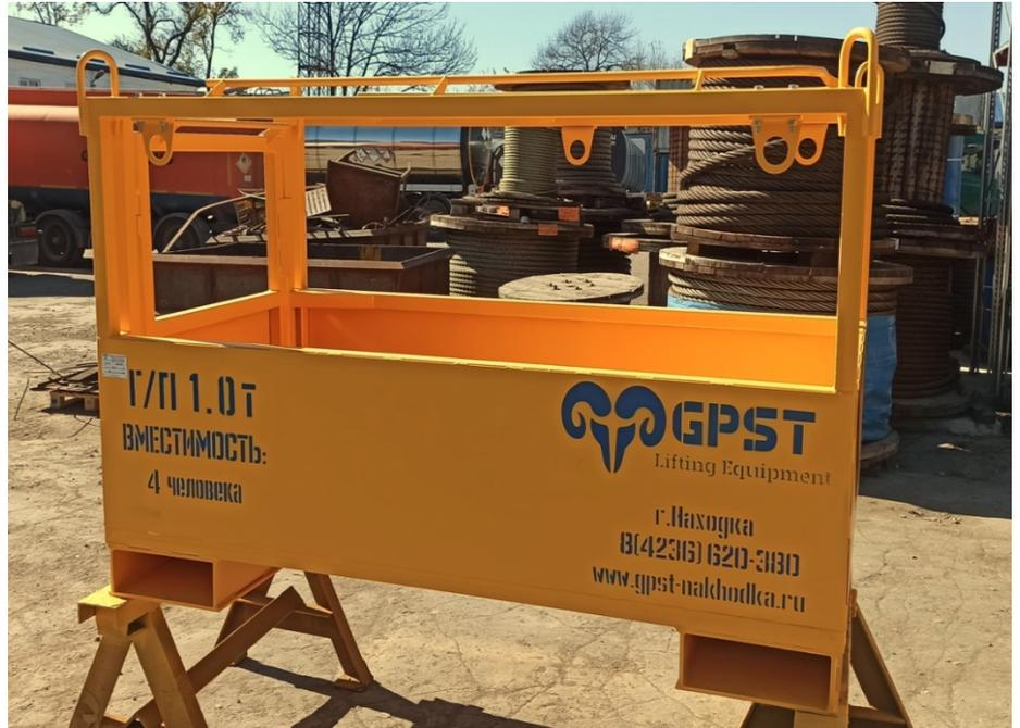
Люлька подвесная на гибких канатных стропах, **облегчённая конструкция без наличия крыши.**
