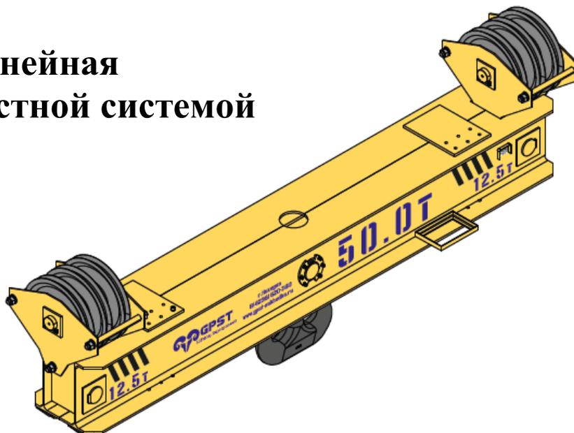
Траверса выполнена в виде двух балок, соединенных между собой стальной пластиной при помощи болтового соединения, металлическими пальцами блочной системы и грузоподъемного крюка. Траверса предназначена для эксплуатации с Козловым краном типа КС50 - 42Б.
