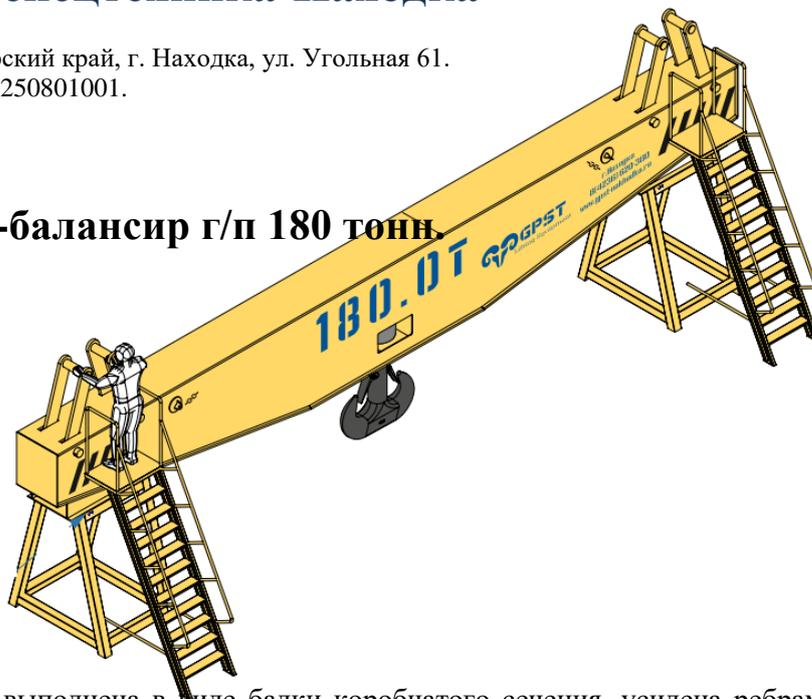
Грузоподъемная траверса - балансир выполнена в виде балки коробчатого сечения, усилена ребрами жесткости, со встроенным двурогим поворотным крюком (DIN 15402 № 100). **Траверса-балансир необходима для возможности совместной работы двух кранов.** Обеспечивает перемещение, монтаж и демонтаж тяжелых частей генератора-статора при замене турбогенератора.
