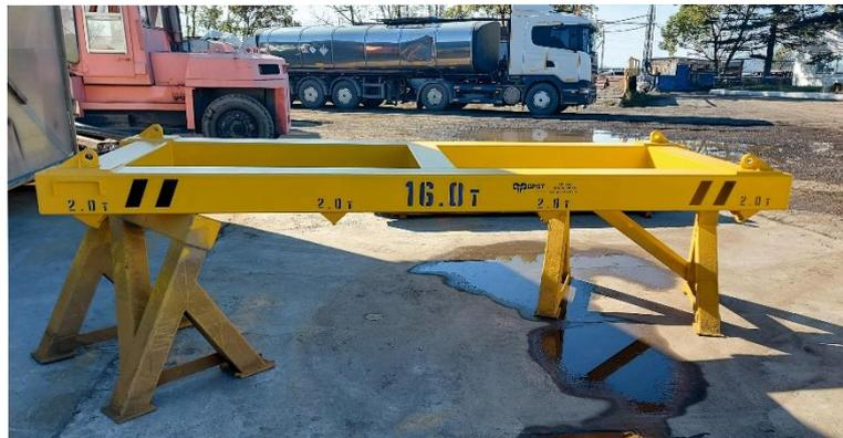
Траверса имеет 8 (восемь) основных грузоподъемных проушин, г/п каждой 2.0 т.
