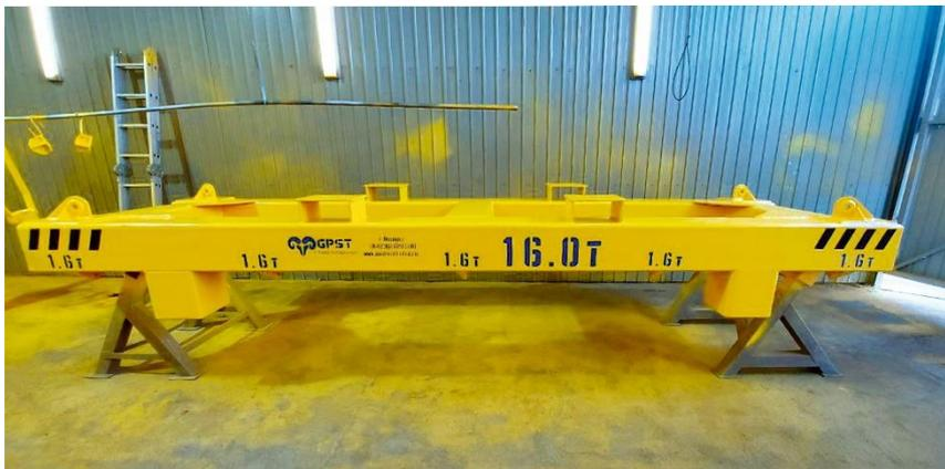
Грузоподъемная траверса общей грузоподъемностью 16.0 т, для подъема и перемещения МКР (мешки «Big-Bag») в количестве 10 (десяти) штук. Траверса укомплектована необходимыми приспособлениями, стропами, скобами для обеспечения строповки.
