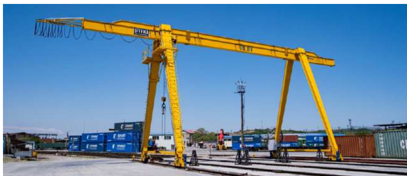
Кран козловой электрический однобалочный г/п 12,0 т, высота подъема 10,0 метров, длина пролета крана 16,0м, рабочий вылет консоли (правая) 6,0м, рабочий вылет консоли (левая) 5,0м. для ООО "ПримТрансКом"
