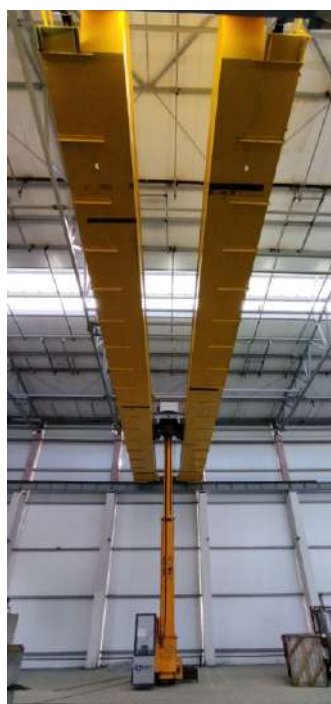
Кран-штабелер мостовой электрический опорный двухбалочный грузоподъемностью 8 тонн, длина моста 23,0м, высота подъема вил 8,0м, с кабиной для АО «ДВЗ Звезда»
