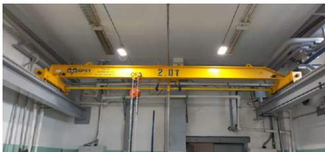
Кран мостовой ручной однобалочный опорный г/п 2,0т, пролет крана 4,5м, высота подъема 3,0м, АО ААК «ПРОГРЕСС», г. Арсеньев
