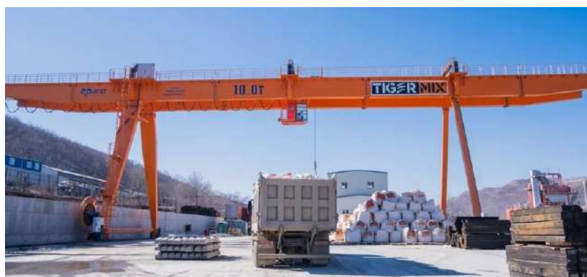
Кран козловой электрический двухбалочный г/п 10,0 т, высота подъема 9,0 метров с кабиной, длина пролета крана 32,0м, рабочий вылет консолей каждая по 12,5м. для Завода ООО "Тайгер Микс"
