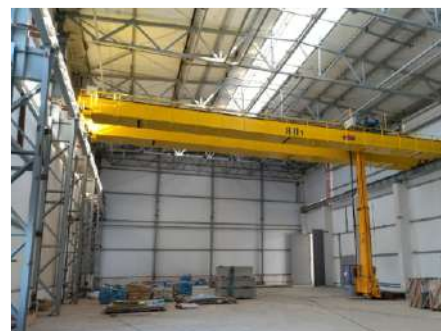
Кран-штабелер мостовой электрический опорный двухбалочный грузоподъемностью 8 тонн, длина моста 23,0м, высота подъема вил 8,0м, с кабиной для АО «ДВЗ Звезда»
