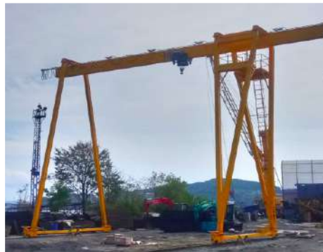
Кран козловой электрический однобалочный г/п 10,0т полная длина 24,0м., консоли 6,0м и 2,0м, высота подъема 9,0 м для АО «Находкинский МТП».
