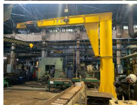
Кран консольный электрических г/п 2,0т в количестве 3 штук для Улан-Удэнского локомотивового ремонтного завода - филиала АО «Желдорремаш», Республика Бурятия, г. Улан-Удэ
