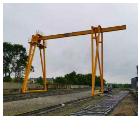
Кран козловой электрический однобалочный г/п 10,0т полная длина 24,0м., консоли 6,0м и 2,0м, высота подъема 12,0м., в комплектации с подкрановым путем длиной 100 м. для АО ТД РЖД ВРК1 г.Уссурийск.
