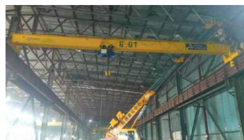
Кран мостовой опорный г/п 6,0 т, высота подъема 8,0м., длина пролета крана 16,5 м для Завода Синергия.
