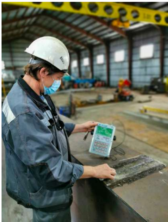
Ультразвуковой контроль сварных швов (УЗК)
