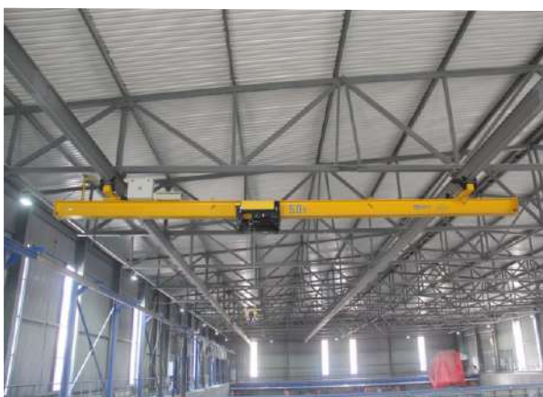
Кран мостовой электрический однобалочный подвесной г/п 5,0 т, высота подъема 6,0м, длина пролета 9,0 м с консолями по 1,5 м для ООО «СДС-Строй», в здание Трансбордера.
