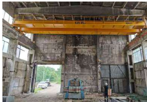
Кран мостовой опорный двухбалочный г/п 10,0 т, высота подъема 9,0м, длина пролета 16,5 м. в п. Раздольное для ООО «Т-Строй»
