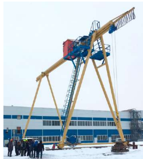
Кран козловой электрический однобалочный г/п 5,0 т., пролет 16,0м длина 24,0м., кабина стационарная для ПАО ААК "ПРОГРЕСС" г. Арсеньев
