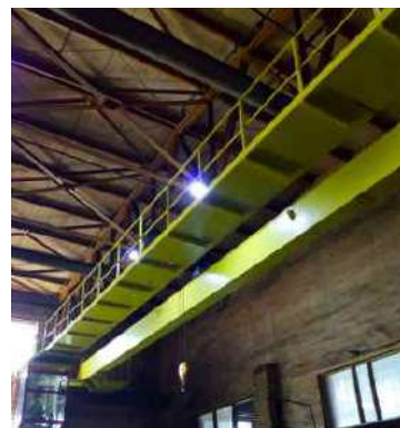
Кран мостовой опорный г/п 5,0т, высота подъема 8м, длина пролета 20м с кабиной для АО ТД РЖД, АО ВРК1 г. Хабаровск
