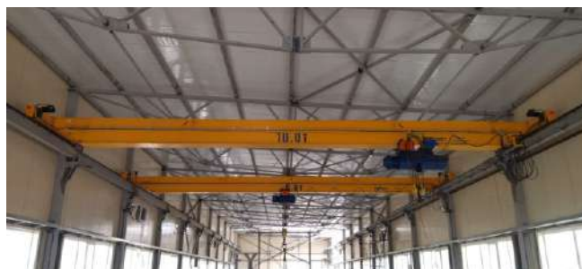
Кран опорный мостовой электрический г/п 10,0т пролет 14,35м, высота подъема 6,0м, Кран опорный мостовой электрический г/п 5,0т пролет 14,35м высота подъема 6,0м, ПАО "Ленское объединенное речное пароходство", Республика Саха (Якутия), п. Жатай.
