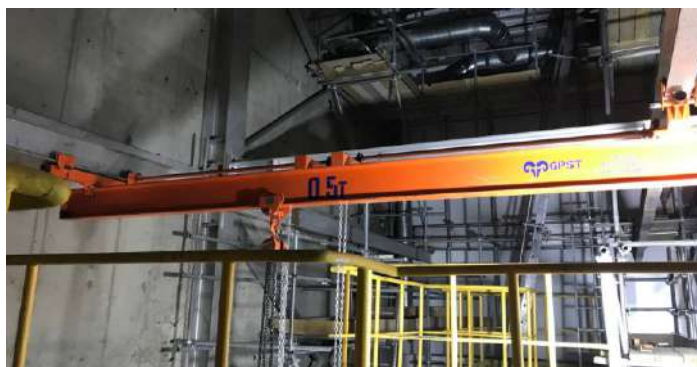
Кран мостовой ручной однобалочный подвесной г/п 0,5 т, высота подъема 10 метров, длина пролета крана 4,2м, вылет консолей 0,3м+0,3м для ООО «Ист КонТех» объект горно-обогатительного комбината (ГОК) «Озёрный» в Республике Бурятия
